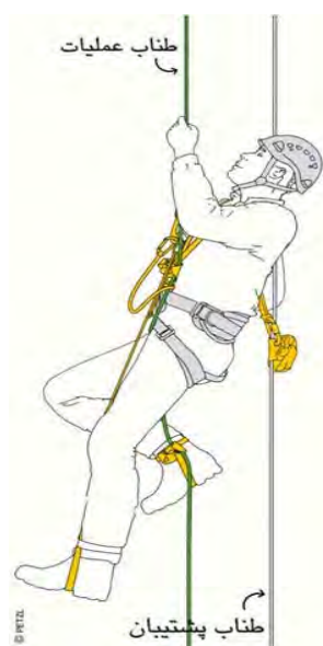
شکل ۲-۱۰- دسترسی با طناب
