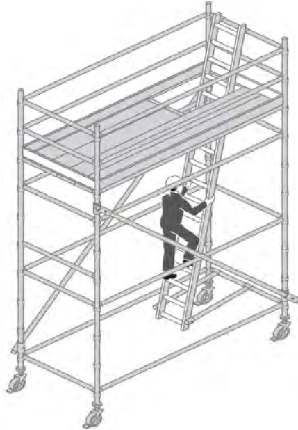
شکل ۲-۷- داربست برجی متحرک
